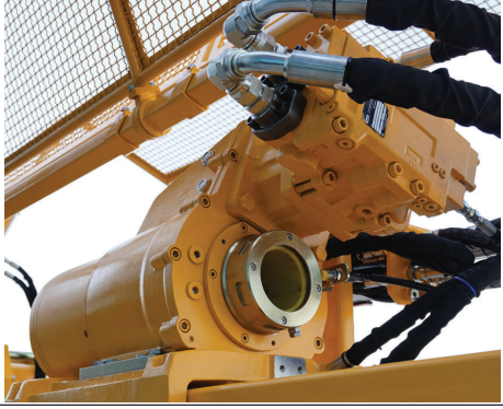
Güçlü delme ünitesi ile NWL çapta 600 m delme kapasitesi.
